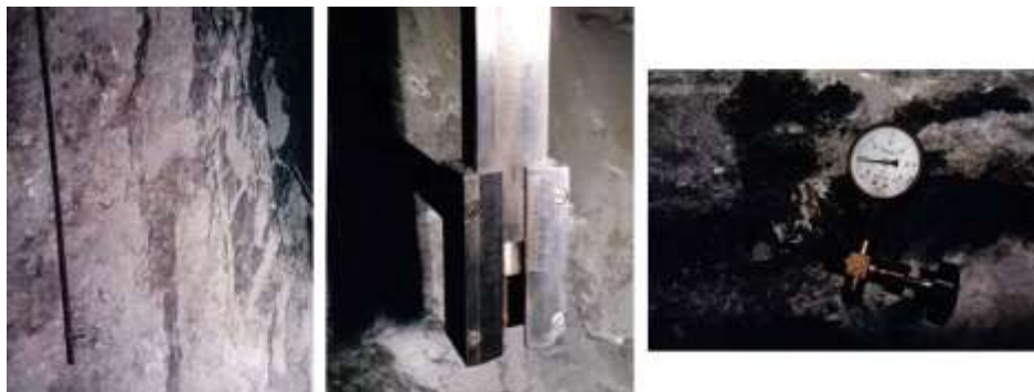
Figura 5.8- Dispozitive de măsurare în pilieri la mina Telegdy.
