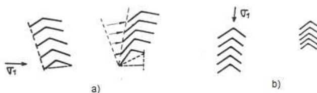
Figura 3.5- Reprezentarea schematică a fibrelor: \sigma_1 – compresiune perpendiculară a) și paralelă b) la axa fibrelor (după Van Hasselt, 1991).
